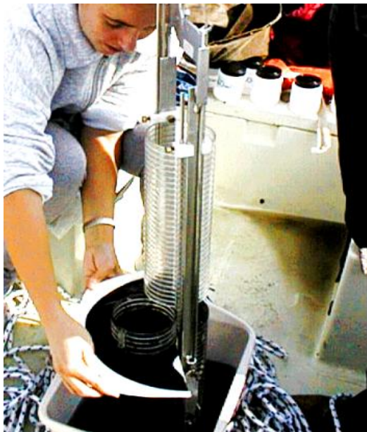
Fig. 9.11: Carotatore utilizzato nei prelievi: il sedimento viene segmentato in fette di 4 cm di spessore e riposto nei barattoli per le analisi (uno per ogni fetta).
