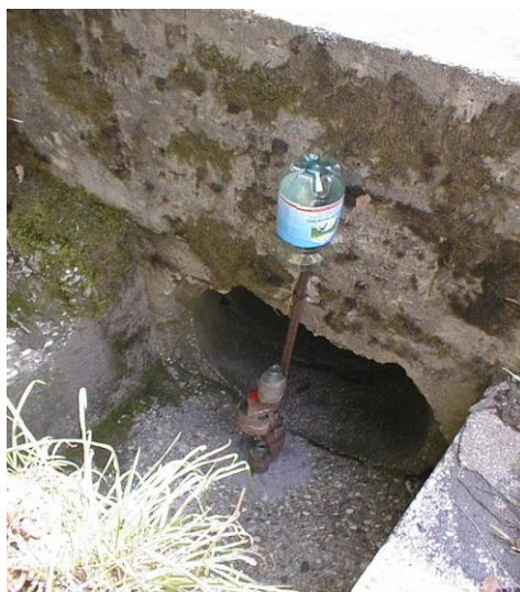
Fig. 9.3: Intercettazione del deflusso nel bacino forestale.
